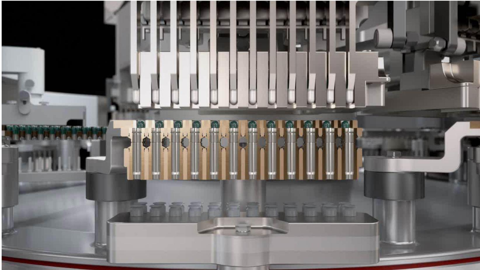
💊 Sistema de ejeção para eliminação das capsula não abertas e perfeito funcionamento do sistema
